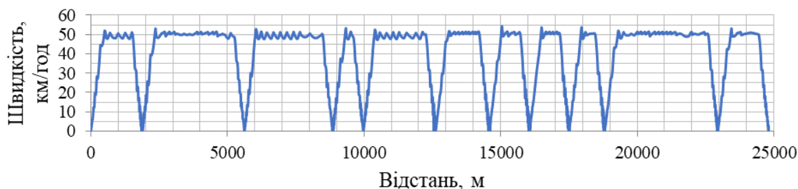
Рис. 3 – Залежність швидкості руху базової секції електропоїзда від пройденого шляху
