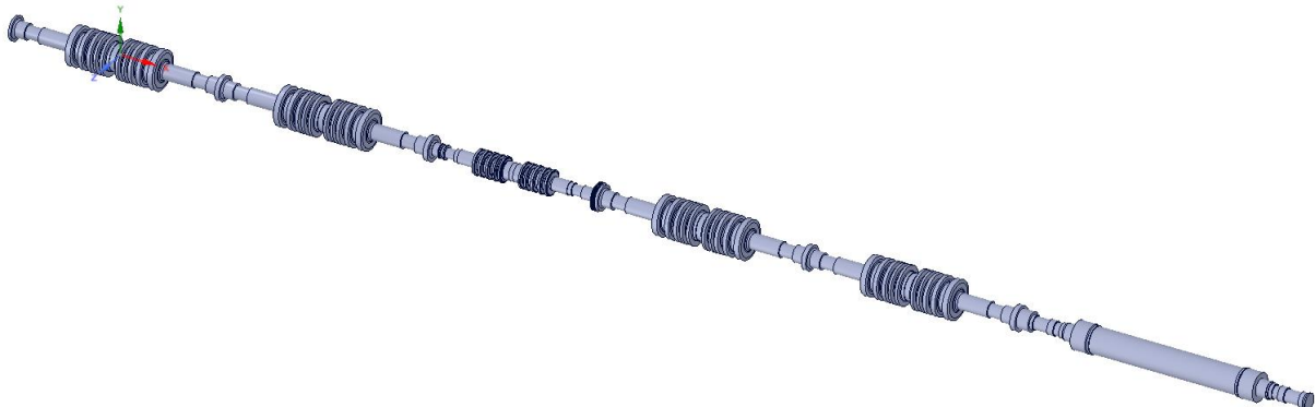
Рис. 1 – 3-D просторовий аналог валопроводу турбоустановки К-1000-60/3000 ЛМЗ Розрахункова оцінка напружено-деформованого стану валопроводу
