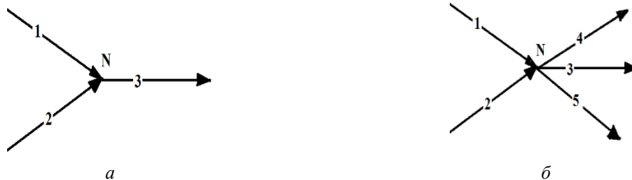
Рис. 1 – Фрагмент гідравлічної мережі з двокомпонентною рідиною: а – з одним вихідним каналом; б – з трьома вихідними каналами
