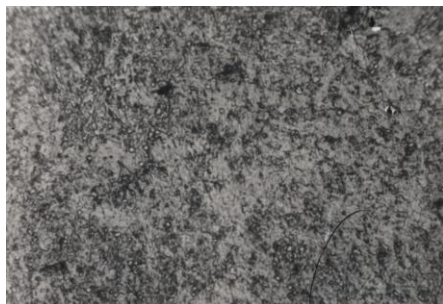
Рис. 1 – Мікроструктура ділянки неповної перекристалізації зони термічного впливу зварного з'єднання зі сталі 12X1MФ. Ресурс 280 тис. год ( \times 360 )
