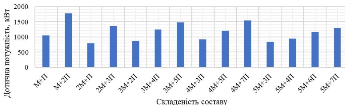
Рис. 2 – Потужність моторного вагону: М – моторний вагон; Π – причіпний
