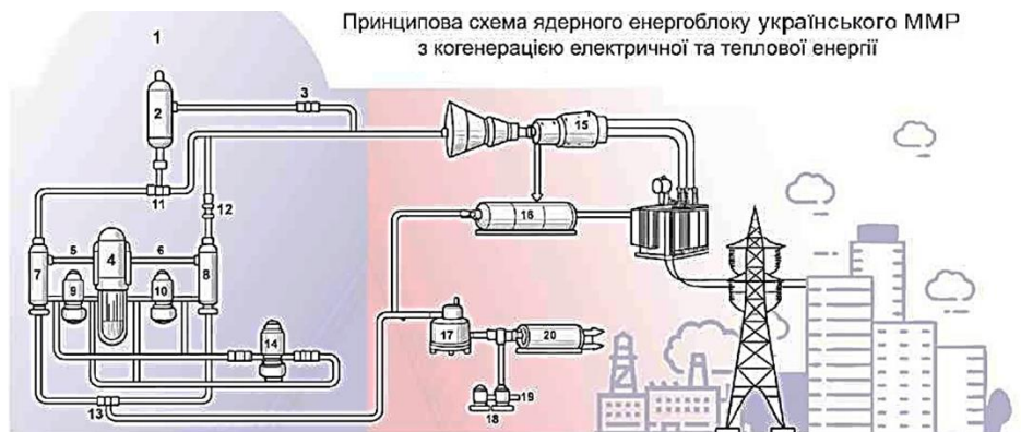
Рис. 1 – Принципова схема енергоблоку українського ММР з когенерацією електричної та теплової енергії:
